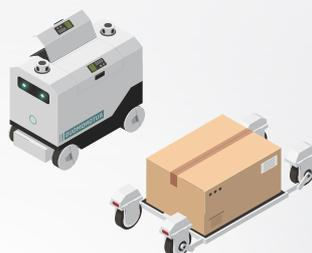
物流拠点や生産現場において導入が進む無人搬送車 (AGV)。自律走行制御ユニットとの連携、カスタマイズによってカメラ画像や各種センシングデータを用いた自律走行制御の開発・検証に活用できます。
