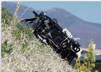
草刈りユニットを装着し、全電動自走式草刈機として利用。自律走行アルゴリズムの実装で、指定範囲の自動草刈による省人化が期待できます。また、ロボットアームとAI画像解析技術の組み合わせで、農作物の自動収穫にも応用が可能です。
